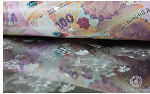
Plancha calcográfica utilizada en la producción de los billetes de Eva
